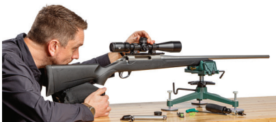
Colimación visual del ánima del arma con la mira.
